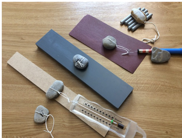
Figure 3 : Atelier expérimental pour étudier la relation entre la force de frottement, l'état d'une surface et le poids d'un objet
